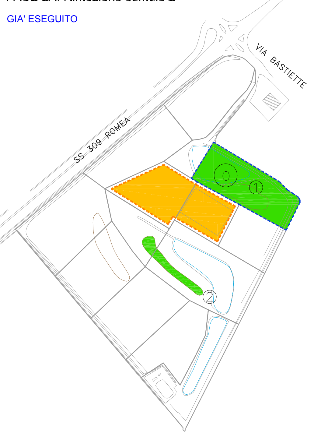
FASE 2: Scavo lotto 0 e creazione piazzola di stoccaggio terreno di scotico FASE 2A: Rimozione cumulo 2 GIÀ ESEGUITO
